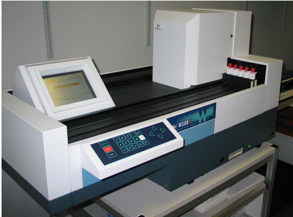
Figur 16-5: Gammatæller med automatisk prøveskifter.
