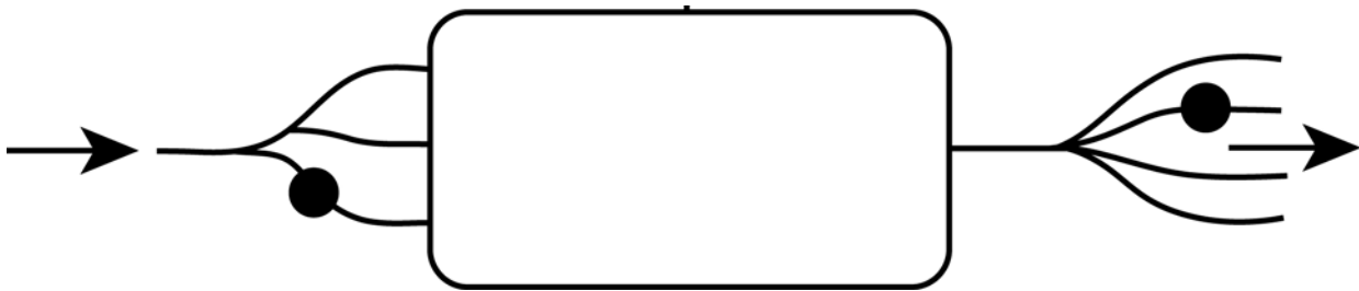
Figur 3-7: Fick's princip, hvor konvektiv flow og ikke-konvektiv fluks kombineres i massebevaringsprincippet. De to prøvetagningssteder illustrerer velblandede indløb og velblandede udløb, hvor henholdsvis indløbskoncentrationen ( C_i ) og udløbskoncentrationen ( C_o ) kan måles.
